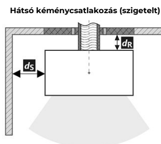
A füstcső áthaladása éghető anyagból készült falon
